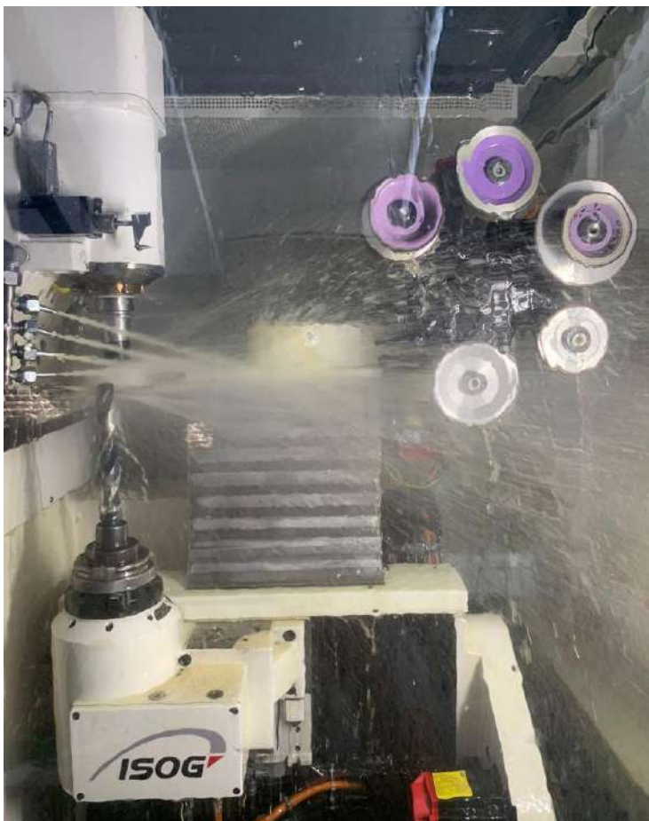
Affilatrice con cambio mola automatico.
