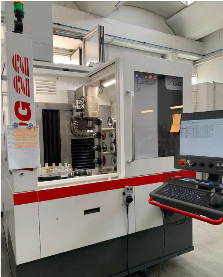
Affilatrice a controllo numerico con caricatore automatico.
